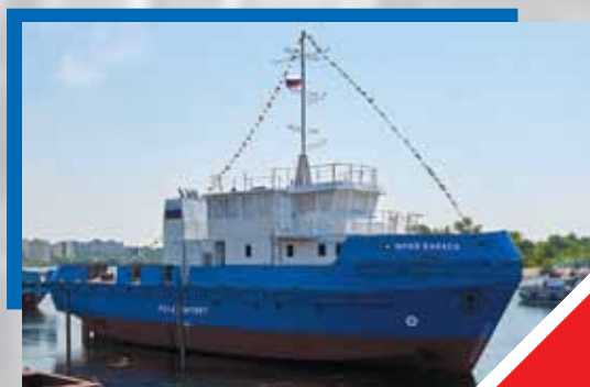
Гидрографический катер, проект E35.Г ДА559 x 2 ед., ДГ 120В.2 x 2 ед., АДГ40В.2 x 2 ед. Суммарная мощность 1,4 МВт.
